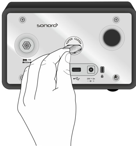
Fig. 8: Inserimento della batteria
