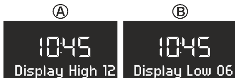
Fig. 16: Impostazione del dimmer per il display.
